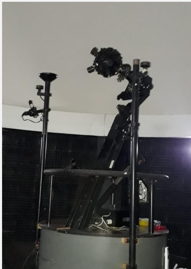
Equipo Carl Zeiss ZKP 1 que sigue en uso para funciones y recorrido por las constelaciones
