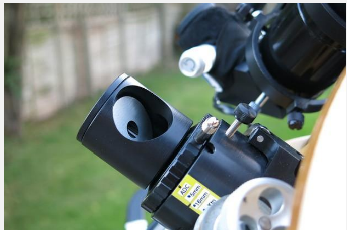
Imagen 5: colimador Cheshire en porta-ocular de telescopio. Skyandtelescope.
