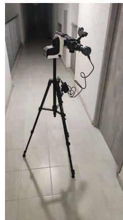
Figura 1: Telescopio compuesto por el Travel Scope 80, cámara SV705C con filtro de corte UV/IR, montura AZ-GTi, control con Raspberry PI y celular, conectado con una power bank de 20000 mah.
