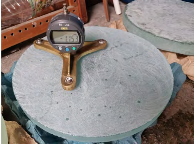
Medición de la curvatura del vidrio con un esferometro
