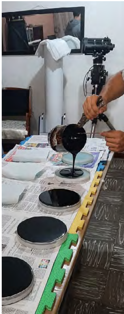
Vertido de brea (arriba) y disposición del peso sobre ella (abajo)
