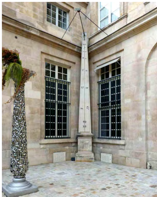
Figura 2 Meridiana de la Casa de la Moneda de París calculada por Pingré en 1778. En el extremo del trípode superior hay un disco con un agujero por el que pasa un rayo de sol que se proyecta sobre la línea vertical al mediodía
