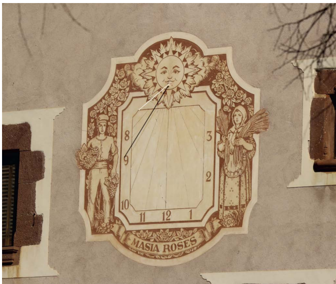
Figura 1. Reloj de hora solar en Masía Rosés, Gavà, Barcelona. Las 12 están en la vertical, indicando el paso del Sol por el meridiano local. La sombra (línea negra) marca unos minutos antes de las 9. El estilete es la línea blanca. Foto: Antonio Bernal
