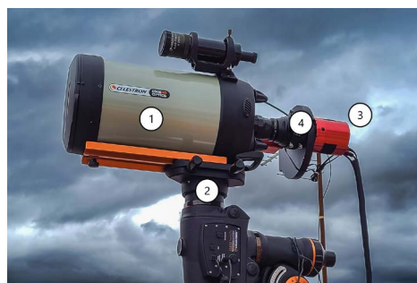
Figura 5. Filtros de banda ancha: L, R, G y B, para obtener color natural y filtros de banda angosta Ha, Oiii y Sii diseñados para capturar longitudes de onda muy específicas. Todos los filtros están dispuestos en una rueda que automatiza el intercambio de estos frente a una cámara monocromática. Fuente: Autor.
